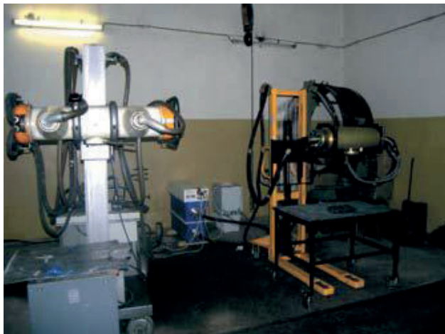
Стационарні рентгенівські апарати РУП 150/300 і «Екстравольт-360» в рентгенівській лабораторії ІЕЗ ім. Є.О. Патона НАНУ
