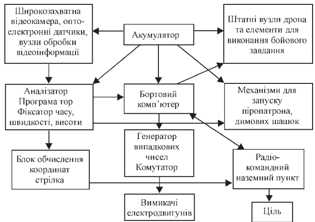
Рис. 3. Блок-схема взаємодії вузлів дрона
