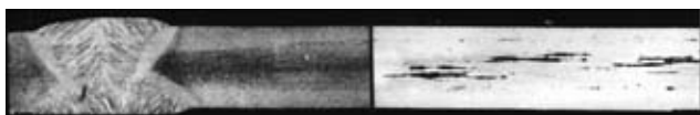
Рис. 1. Макрошлиф с дефектами в прикромочной зоне сварного соединения труб (неметаллические строчные включения)
