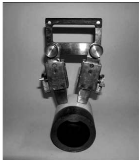
Рис. 3. Общий вид переставного НУ ЭМ-13 при МПК детали в виде фрагмента трубы
