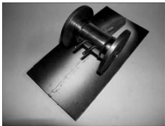
Рис. 4. Общий вид передвижного НУ ЭМ-2 при МПК участка сварного соединения
