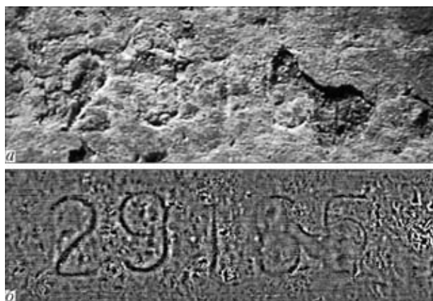
Рис. 8. Корродированная поверхность (толщина коррозии 0,3...0,5 мм): а — изображение поверхности тест-образца; б — МОВ МГ поверхности тест-образца
