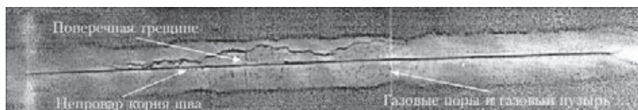
Рис. 5. Сварной шов: пористость, трещины и непровар
