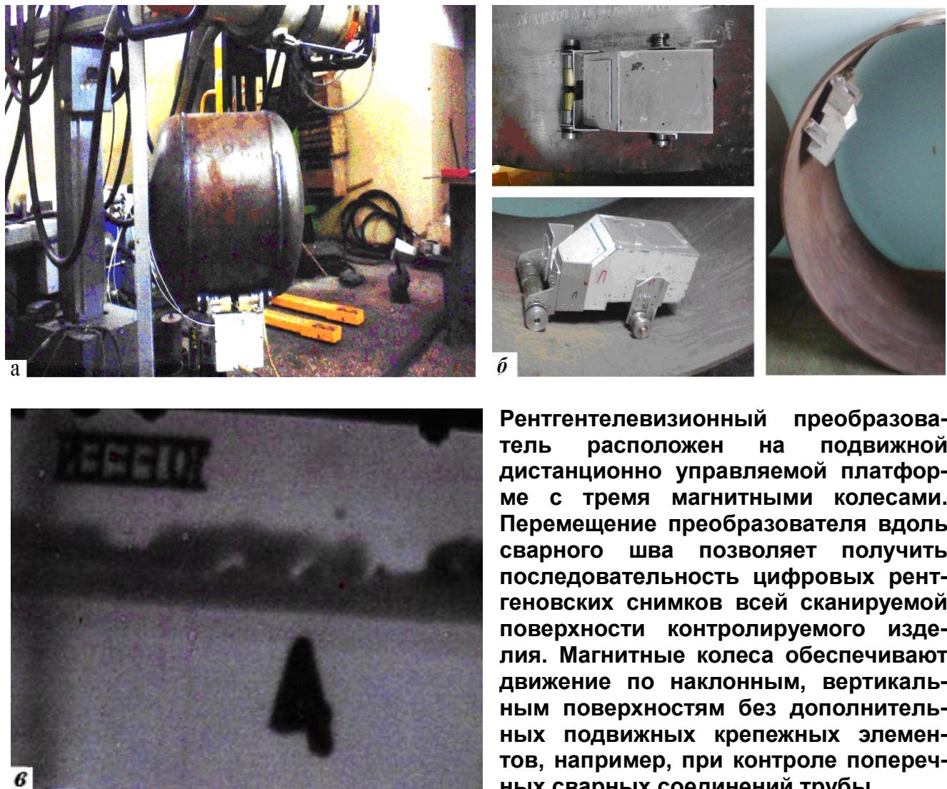
Рентгентелевизионный преобразователь расположен на подвижной дистанционно управляемой платформе с тремя магнитными колесами. Перемещение преобразователя вдоль сварного шва позволяет получить последовательность цифровых рентгеновских снимков всей сканируемой поверхности контролируемого изделия. Магнитные колеса обеспечивают движение по наклонным, вертикальным поверхностям без дополнительных подвижных крепежных элементов, например, при контроле поперечных сварных соединений трубы.
