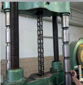
Випробування ланцюга на розтяг на 100 тн розривній машині
