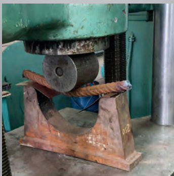
Випробування арматури діаметром 25 мм на загин
