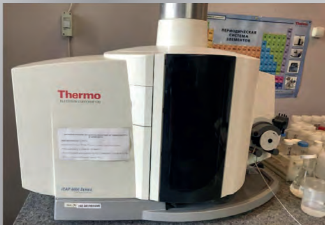
Спектрометр ICAP 6500 DUO (Thermo Fisher Scientific, USA). Емісійний спектрометр для аналітичних досліджень атомного складу неорганічних матеріалів
