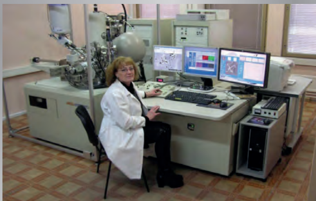
JAMP-9500F (JEOL Ltd, Японія). Оже-мікрозонд з польовим емісійним катодом для аналізу елементів від берилію до урану
