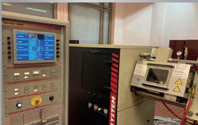
GLEEBLE-3800 (DSI, USA). Автоматизована динамічна система для моделювання (імітації) термодформаційного стану металів
