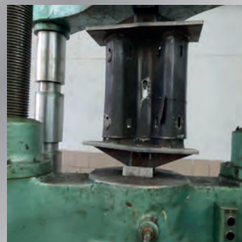
Випробування на розрив дорожнього бар'єрного огородження
